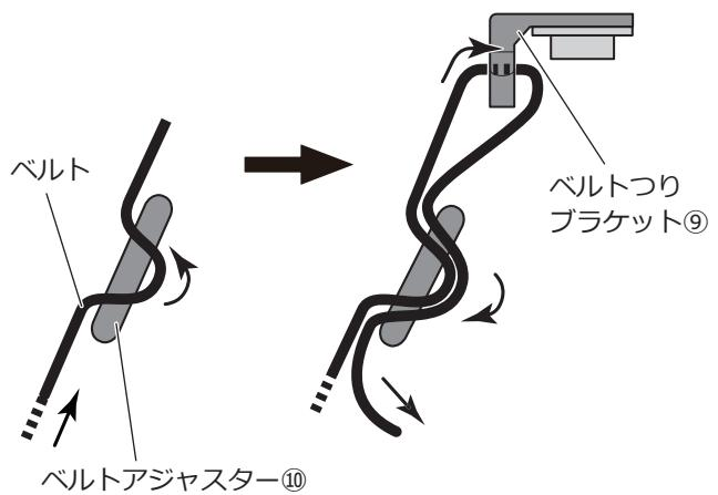
□フロントマッドガード①のベルトがたるまない程度に調整し、左右のバランスを整えます。
