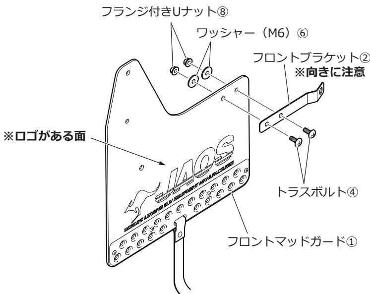
□図の部品を使用して、フロントマッドガード①にフロントブラケット②を取り付けます。
