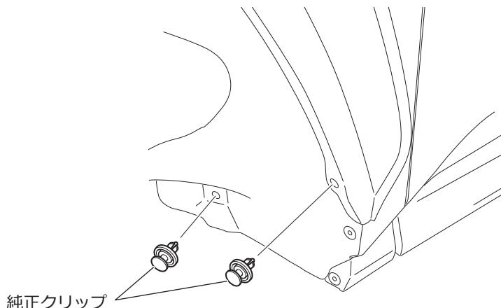
□タイヤハウス後方の純正クリップを取り外します。
