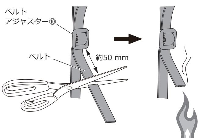
□ベルトの余りを約50 mm残して、不要な部分をハサミでカットします。
