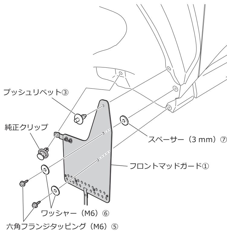
□図の部品を使用して、フェンダー部にフロントマッドガード①を仮組みします。
