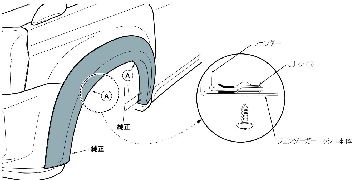
**アドバイス** 純正スクリューで固定する3箇所と本体(フロント)①の穴を合わせて基準とし、取り付け位置を決めてください。
