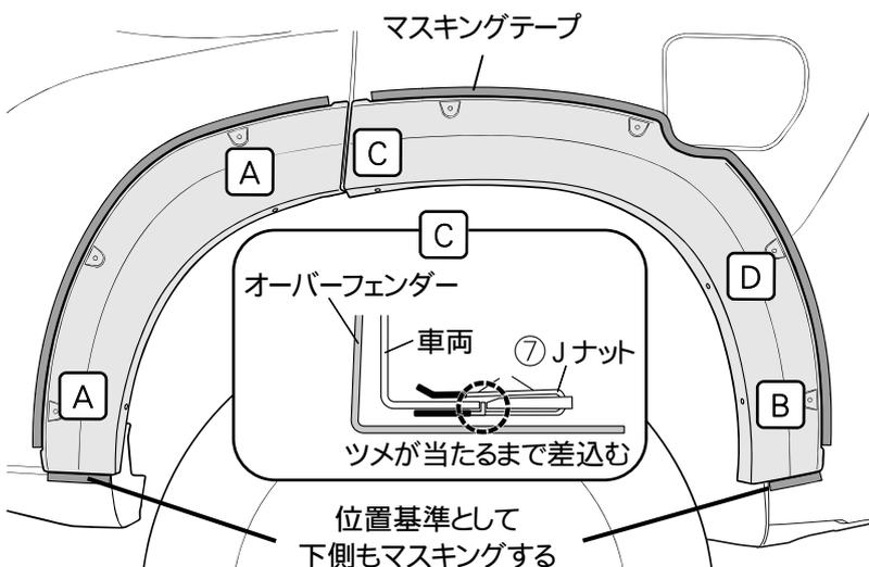
・本体②(リヤドア)をドア淵に合わせてBの位置をタッピングA①で仮組みし、本体②の外淵に沿ってマスキングテープでマスキングします。
