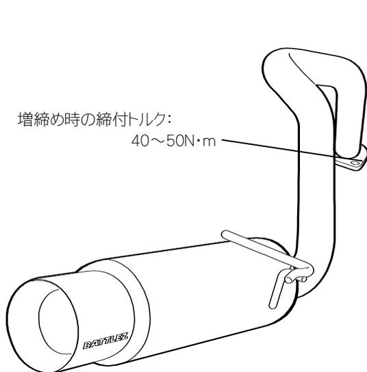
**!** **注意** ボルト類を締付ける場合は2点を交互に締付けるようにしてください。偏った増し締めをすると取り付け際にテールがバンパーに接触したり、ガスケットがうまく密着せず排気漏れを起こす原因となります。
