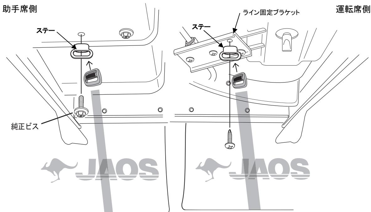
7. 助手席側へのステーの取り付けは車体裏の純正ビスを外し、ステーと一緒に共締めして下さい。
