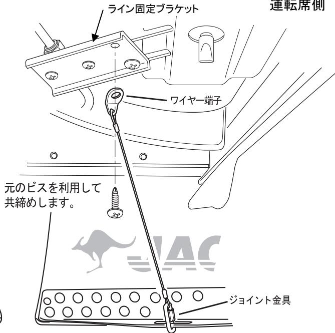
7. 助手席側のハンガーワイヤーの取り付けは車体裏の純正ビスを外し、ワイヤー端子と一緒に共締めして下さい。
