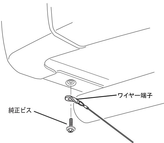
9. リヤバンパー後側面内側にある元のビスを外しワイヤー端子と一緒に共締めして下さい。
