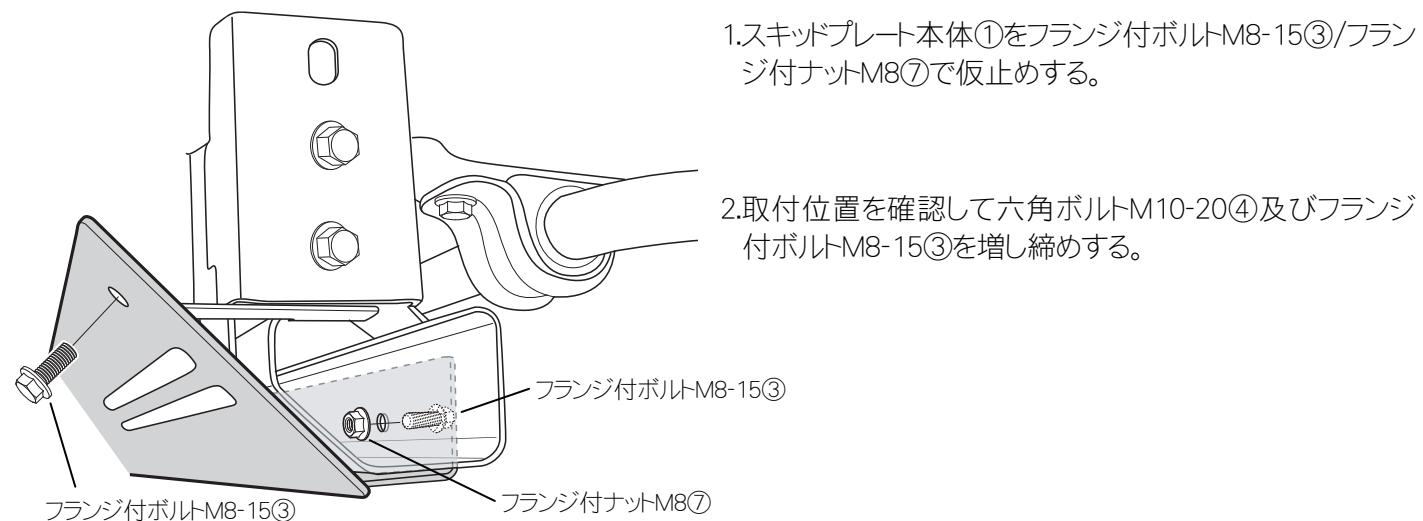
1.スキッドプレート本体①をフランジ付ボルトM8-15③/フランジ付ナットM8⑦で仮止めする。
