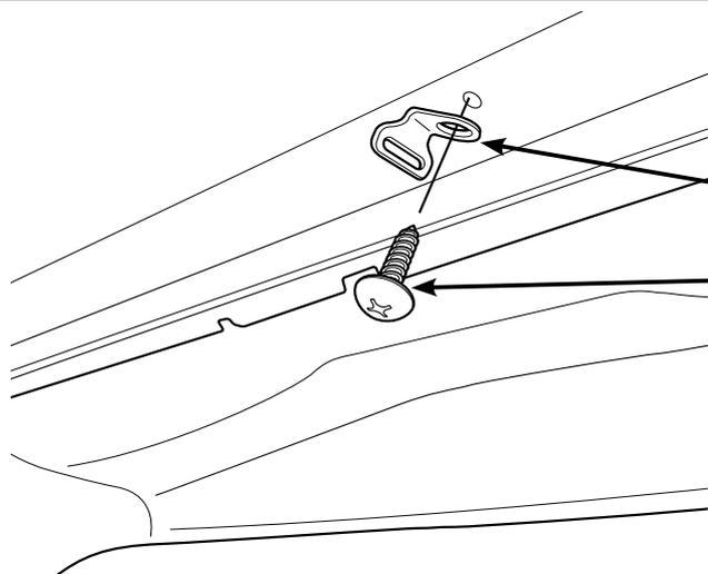
1. サイドシル外側にある純正タッピングを利用して汎用マッドガード付属ステーを取り付けてください。
