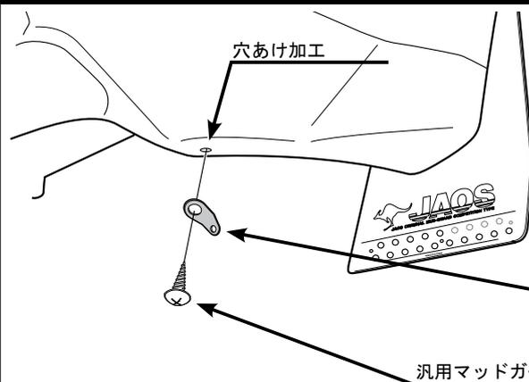
1. リヤバンパー下側に汎用マッドガード付属ワイヤー固定金具を汎用マッドガード付属タッピングを使用して取り付けてください。
