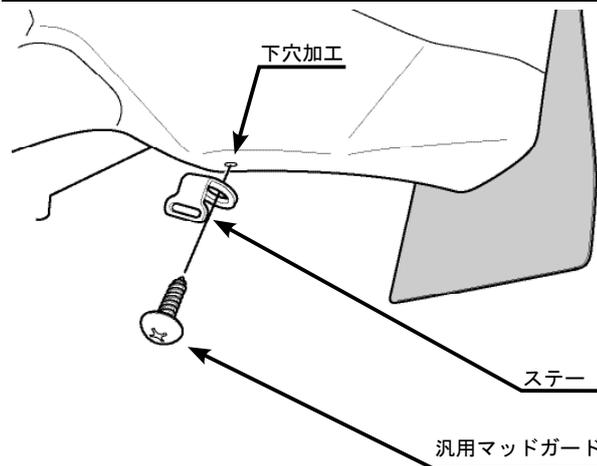
1. リヤバンパー下側にマッドガード付属タッピングより細目のドリルビットで下穴を開けます。
