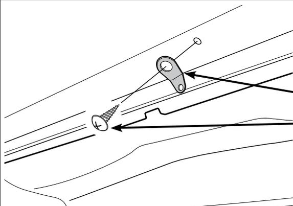
1. サイドシル外側にある純正タッピングを利用して汎用マッドガード付属ワイヤー固定金具を取り付けてください。
