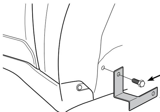
1. フロントブラケット①を純正ボルトを使用して取り付けてください。
