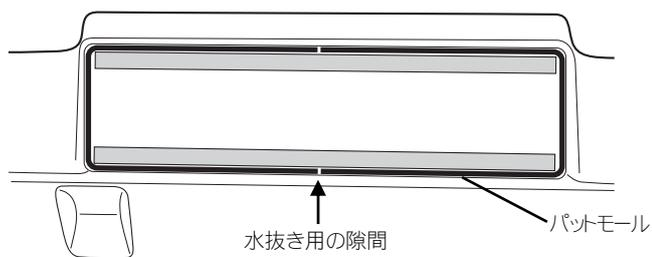
1.左図のようにセンター固定部/サイド固定部にパットモール③を取り付ける。
