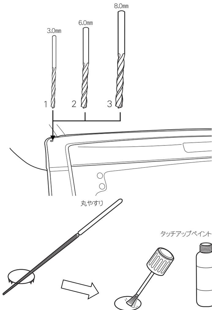
1.マーキングした位置に下穴としてドリルで3.0mm→6.0mmと開けていき、最後に8.0mmで本穴を開けて下さい。
