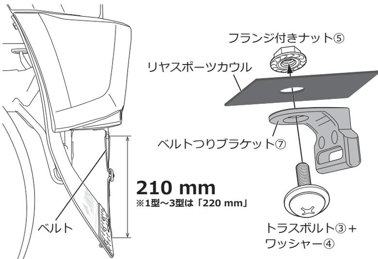
□左図を参照し、トラスボルト③、ワッシャー④、フランジ付きナット⑤を使用して、リアスポーツカウルの穴あけした箇所にベルトつりブラケット⑦を取り付けます。
