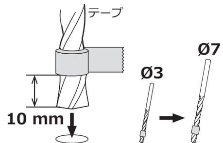
❗アドバイス | ドリルの突き抜けを防ぐため、先端から10 mmの位置にテープを巻いてください。
