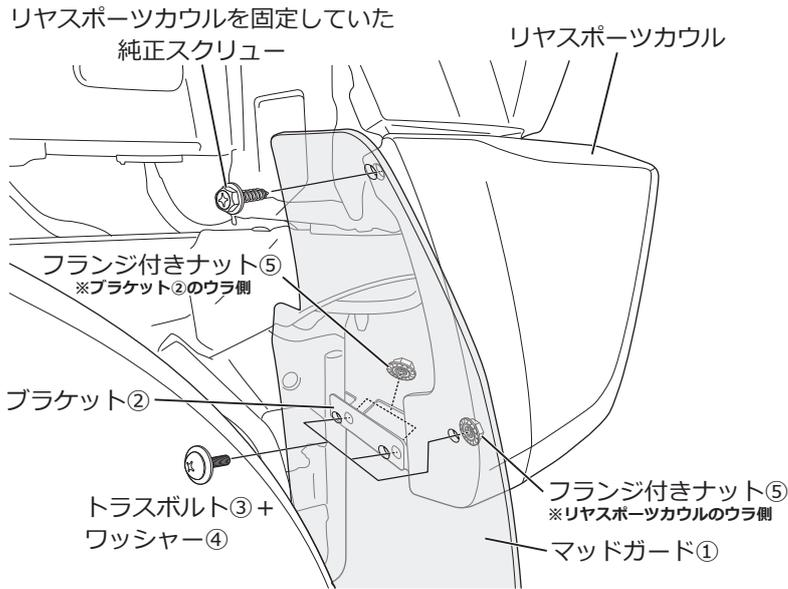
□左図を参照し、マッドガード①をリアスポーツカウルに仮組みします。
