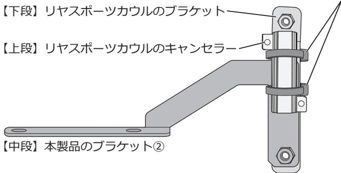
□リヤスポーツカウルのブラケットとキャンセラー、本製品のブラケット②を左図の順に重ねて、耐熱結束バンド⑧を図の箇所巻き付け固定します。
