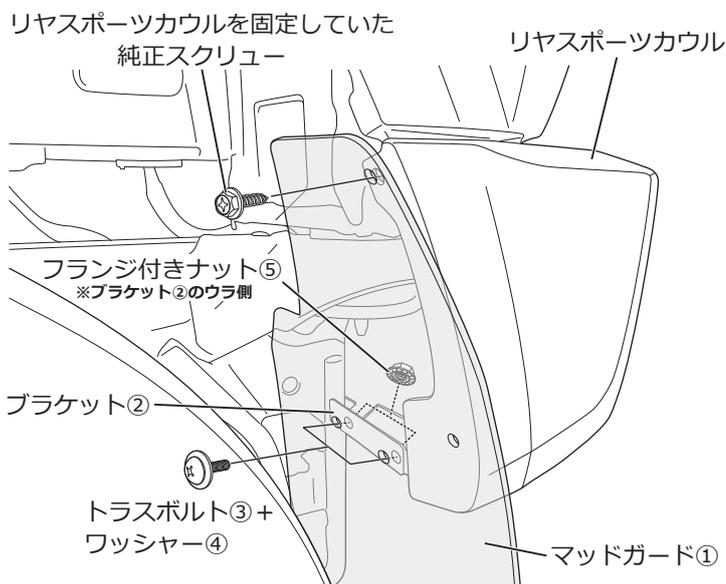
□左図を参照し、マッドガード①をリヤスポーツカウルに仮組みします。
