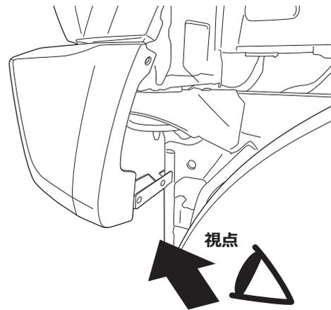
□左図を参照し、フレームエンドの補強角にブラケット② ASSYを差し込み、穴位置を合わせてリヤスポーツカウルの付属品で仮組みします。
