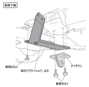
タイダウンと図示の車両ボルトを使用して、ブラケット A⑦、B ⑧を仮固定します。
