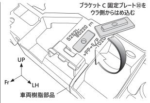
• 図を参照し、ブラケット C 固定プレート⑩を車両樹脂 部品の角穴にはめ込みます。
