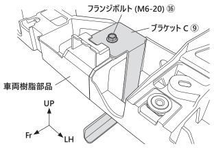
•ブラケット C 固定プレート⑩の上にブラケット C ⑨を載せて、フランジボルト (M6-20) ⑯で固定します。
