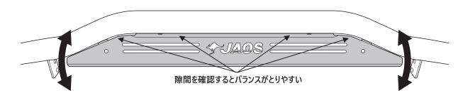
• プレートの取り付けバランスを確認したら、仮組みしていた部分を本締めします。
