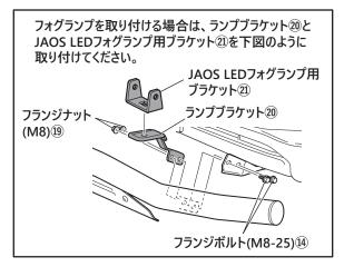
Ŷ アドバイス 「JAOS LED フォグランプ 26C」を取り付け る場合は、JAOS LED フォグランプ用ブラ ケット21をランプに取り付けてあるブラケット と交換し、ランプブラケット20の穴に組み 付けます。
