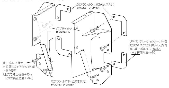
・ブラケットD④⑤をリヤベンチレーションルーバーの穴からボディ裏面へ挿入し、純正スペアタイヤブラケットの取り付け穴に合せブラケットD④⑤をマスキングテープなどで固定をし、ブラケットA①を純正ボルトにて仮組みします。
