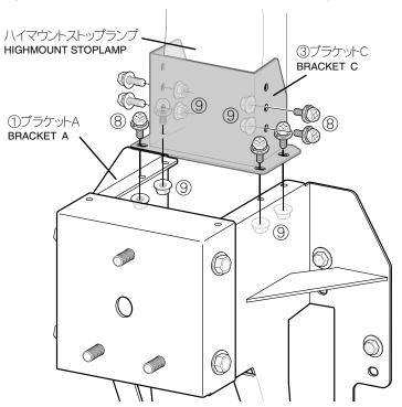
・ブラケットC③をブラケットA①の上面に置き、付属のボルト類®⑨にて固定します。
