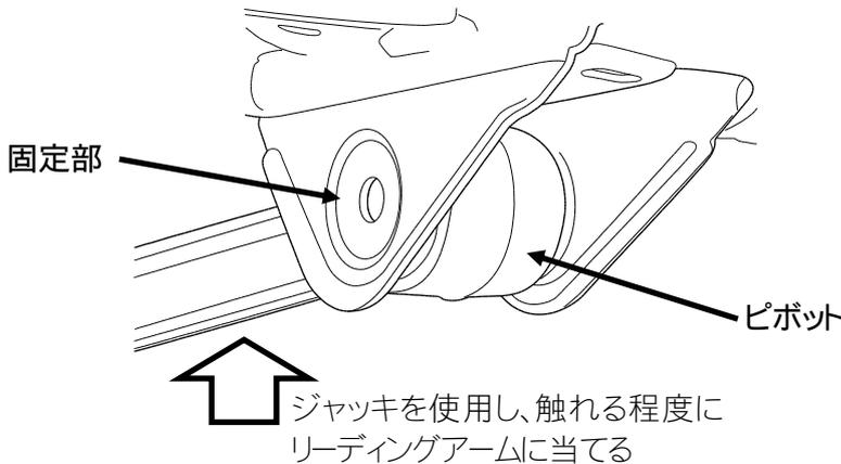
・リーディングアームを固定するボルトを取り外しますが、先にリーディングアームのピボットと固定部の穴位置がずれないように、アーム自体にジャッキを当てます。
