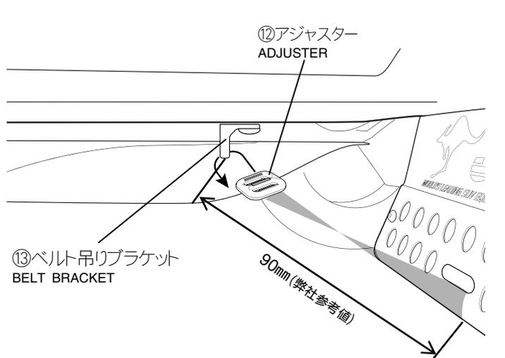
・マッドガード本体に取り付けてあるベルトをマッドガード汎用に付属しているアジャスター⑫を使い、ベルト吊りブラケット⑬へ取り付けます。
