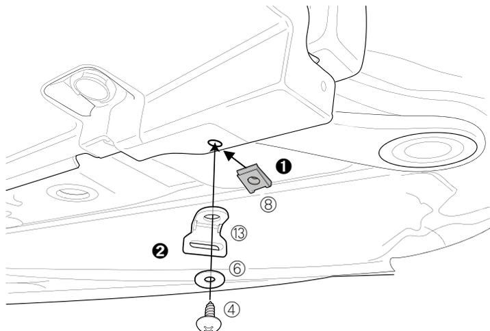
①サイドスポイラーのエンド下部にある穴へスピードナット⑧を差し込み、穴を合わせます。
