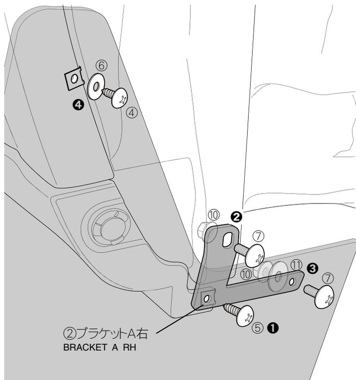
①前項4と同じ要領で加工したマッドガードをブラケットA②で抑え、M5-20タッピングスクルー⑤を**仮組み**します。
