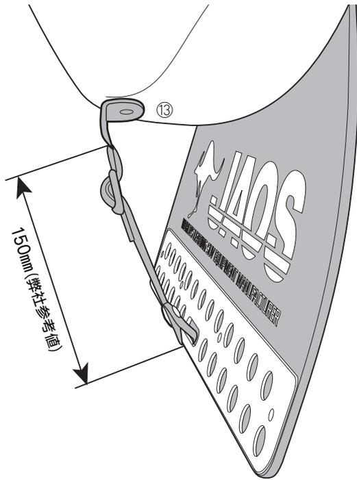
・マッドガード本体に取り付けてあるベルトをマッドガード汎用に付属しているアジャスター⑫を使い、ベルト吊りブラケット⑬へ取り付けます。
