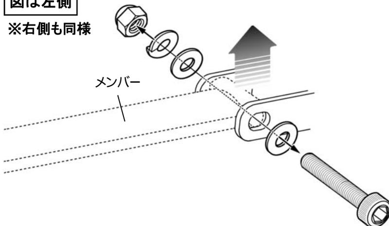
・アルカーボンタワーバー本体に組付けてあるボルト類をすべて取外します。
