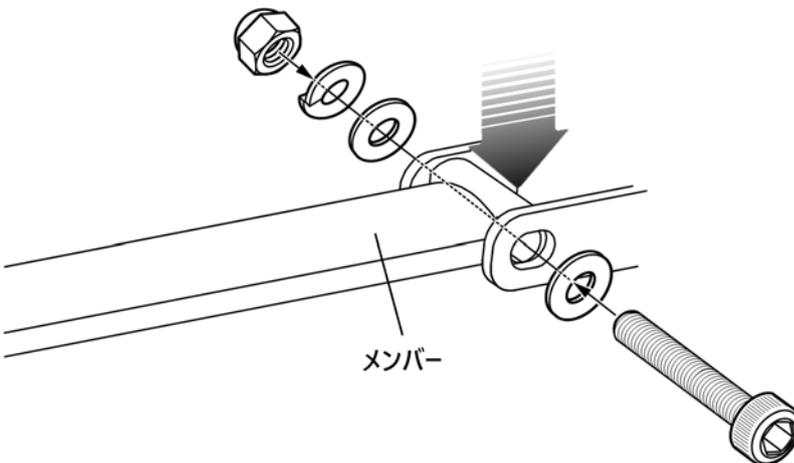
・分解したアルカーボンタワーバー本体①のブラケットをストラットマウント部に配置します。
