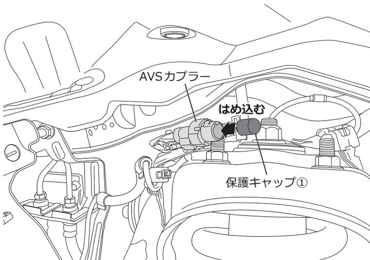
□左図を参照し、フロント側の使用しないAVSカプラーに保護キャップ①をはめ込みます。
