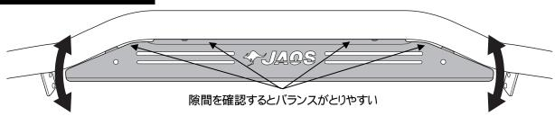
・プレートの取り付けバランスを確認・調整し、仮組みしていた部分を本締めします。
