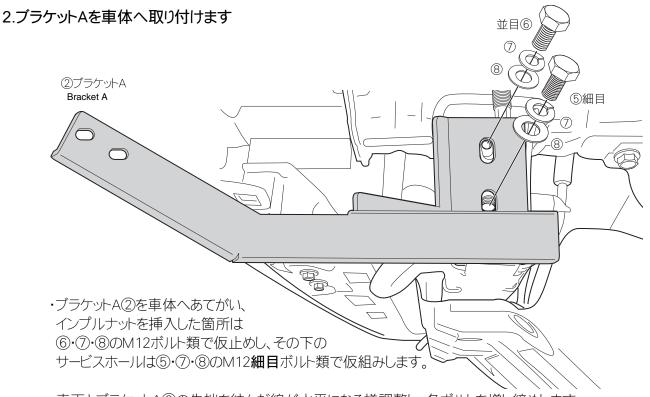
・車両とブラケットA②の先端を結んだ線が水平になる様調整し、各ボルトを増し締めします。 M12推奨締め付けトルク:35~40N·m
