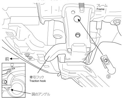
・牽引フックの付け根にあるサービスホール ヘインプルナットM12⑨を挿入します。 (下図を参照)
