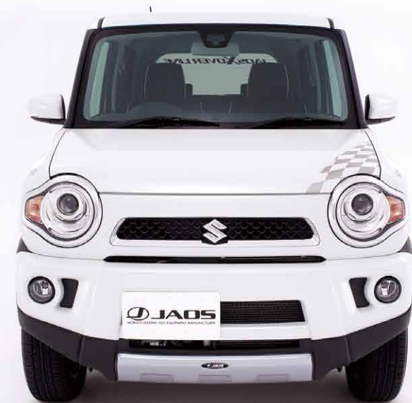
JAOSフロントスポーツカウル ■FRP/未塗装/1ピース/アルミメッシュネット付 ■ボルトオン ■フォグランプは純正流用(未装着車の場合は別途必要) ■インナーフェンダーのカットが必要 ■左画像の赤線で囲った部分が一体となった商品です。デモカーには三色で塗り分けて装着しています
