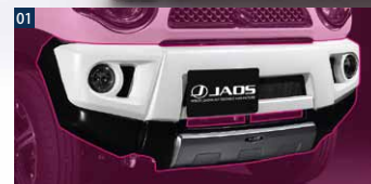
JAOSフロントスポーツカウル ■FRP/未塗装/1ピース/アルミメッシュネット付 ■ボルトオン ■フォグランプは純正流用(未装着車の場合は別途必要) ■インナーフェンダーのカットが必要 ■左画像の赤線で囲った部分が一体となった商品です。デモカーには三色で塗り分けて装着しています
