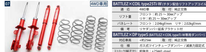
BATTLEZ×SUS セット ■BATTLEZ×COIL type25Ti-W+BATTLEZ×DP typeS ■リヤダンパー延長ブラケットは付属しません
