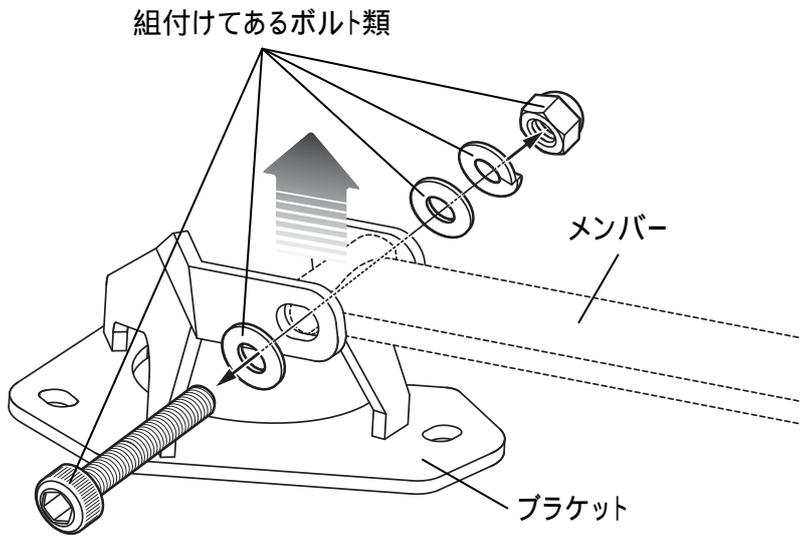
・①アルカーボンタワーバー本体に組付けてあるボルト類を全て取外し、メンバー部を取外します。
