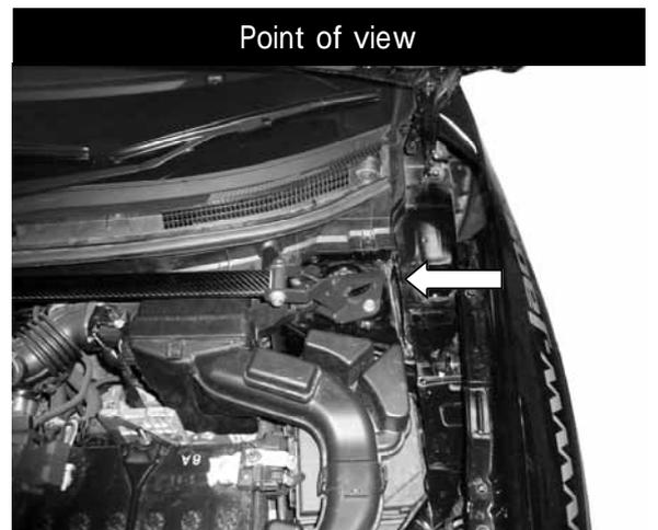
・ストラットマウント部の純正ボルトを取外します。
