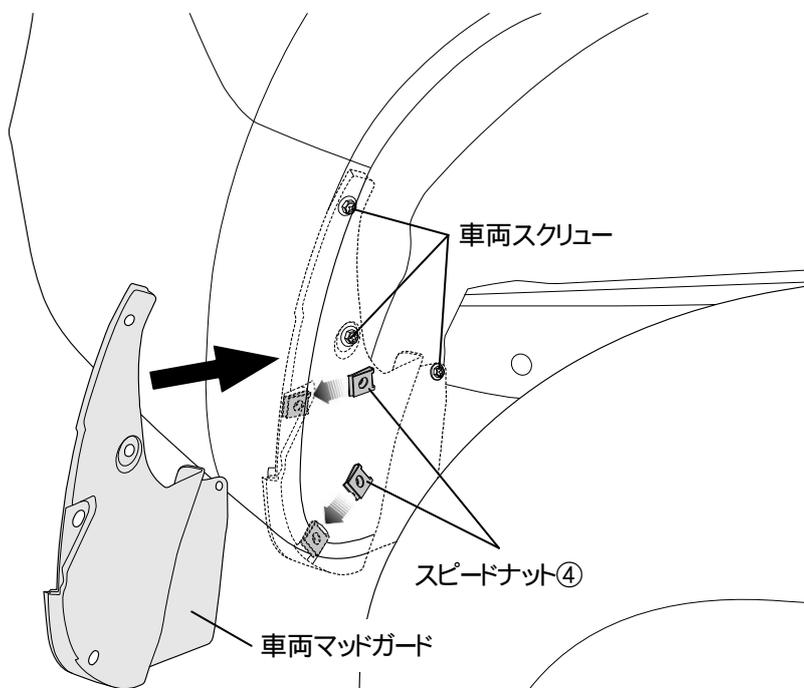
・図を参照し、リヤバンパーの車両クランプ部にスピードナット④を取付けます。
