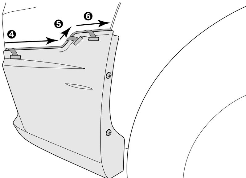
**⚠注意** 両面テープの接着面は剥がれやすい表面になっているため、接着面をドライヤーであたため、確実に取付け圧着してください。
