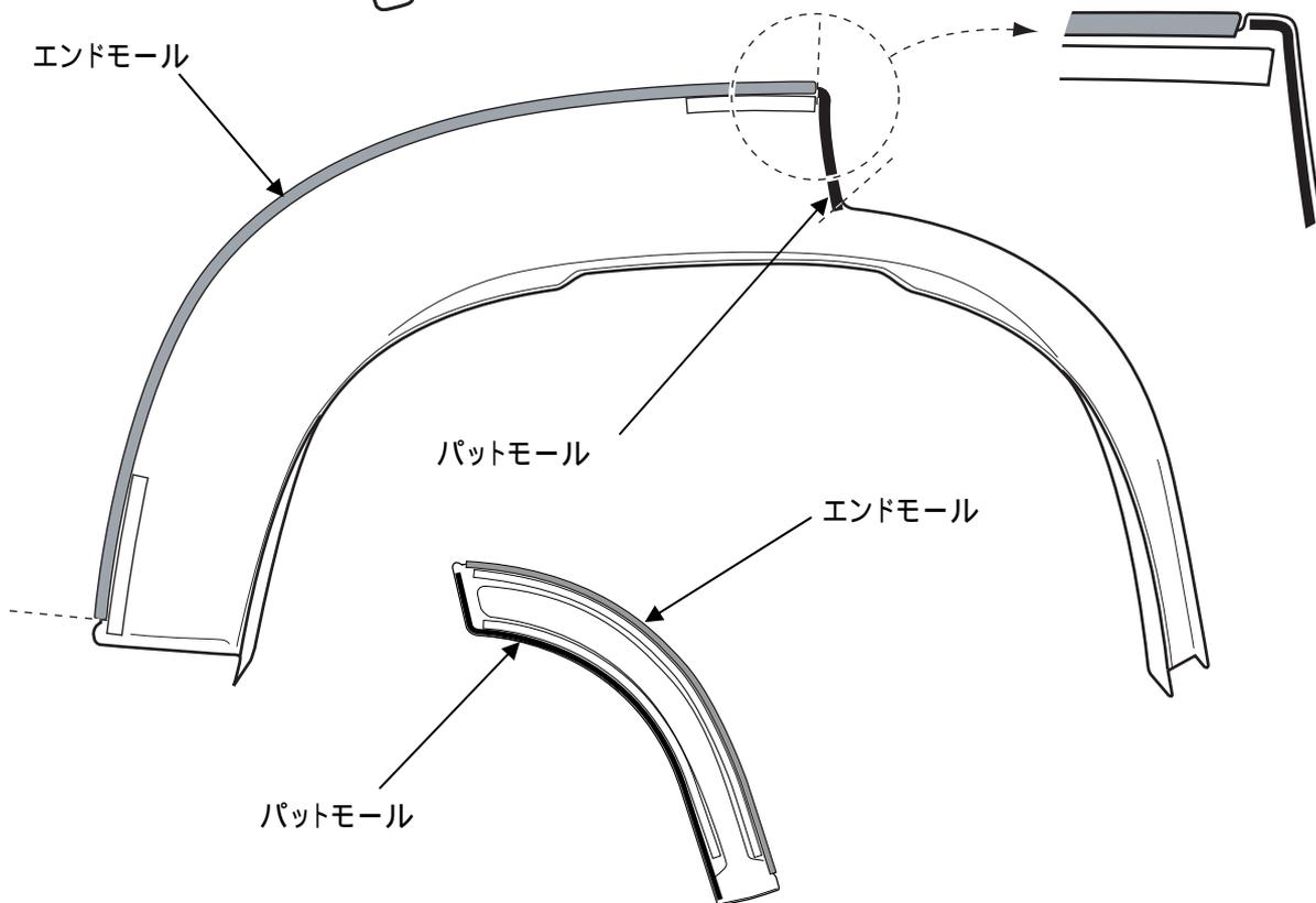
・本体リヤ ,リヤドア部 にエンドモール 及びパットモール を図のように貼り付けて下さい。
