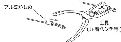
4：ワイヤーが完成したら、ジョイント金具とワイヤー端子を組み付けます。取付は、各マッドガード取扱説明書を参考にしてください。
