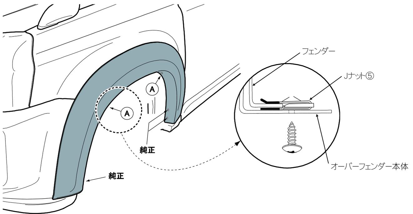
**アドバイス** 純正タッピングスクルー穴位置と本体フロント①の穴位置を基準にして取付位置を合わせて
