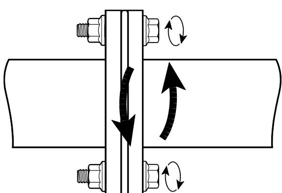
**注意** ボルト類を締付ける場合は2点を交互に締付けるようにして下さい。偏った増し締めをするとガスケットがうまく密着せずに排気漏れを起こす原因となります。
