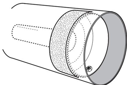
インナーサイレンサー本体を一度外して、干渉する部分に左図のように耐熱テープを適当な長さに切り、インナーサイレンサー本体とマフラーの間に挟み込んで密着を確保して下さい。
