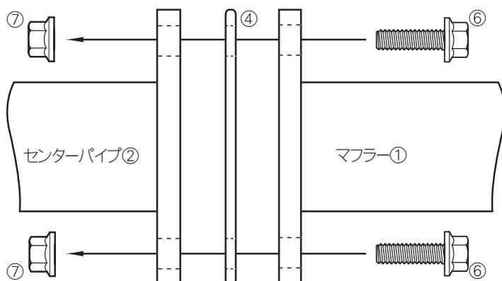
・マフラー①とセンターパイプ②の間にガスケット④を挿入し、フランジ付ボルト⑥・ナット⑦にて仮組みします。
