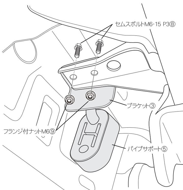
・純正ブッシュが装着されていた部分にブラケット③をセムスボルトM6-15 P3⑧とフランジナットM6⑨を固定します。
