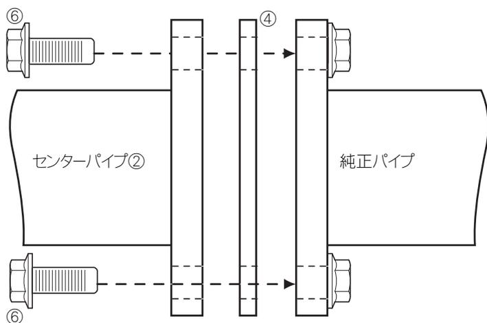
・純正パイプとセンターパイプの間にガスケット④を挟みフランジ付ボルトM10-35⑥にて仮組みします。
