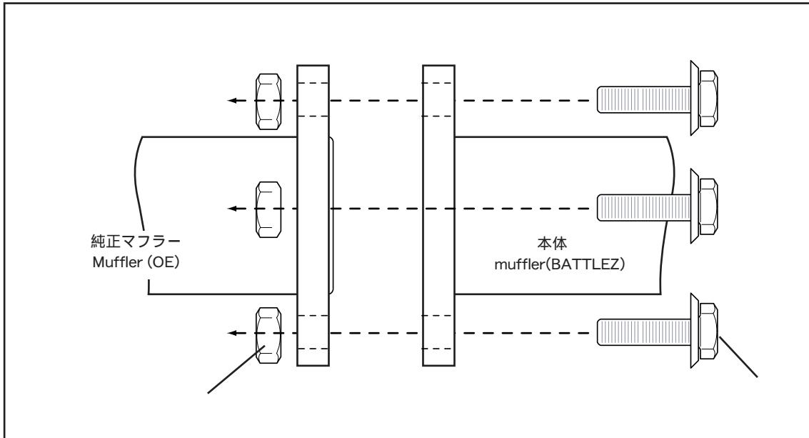
[4] マフラー本体 の位置関係、車両各部とのクリアランス及びフランジ間のずれが無いことを確認しながら仮組み付けしてあったボルトとナットを増締してください
